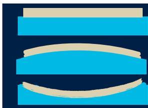
Gracias a la particular elasticidad de la silicona, Rollerpress se ajusta a cualquier curvatura de la baldosas, para una aplicación uniforme del engobe refractario.
